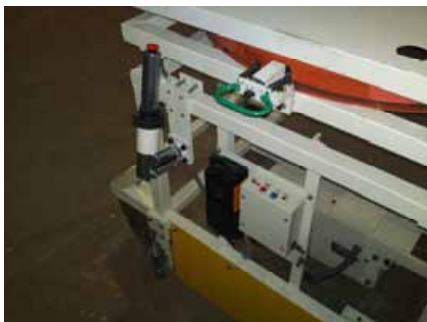
低荷重牽引向け小型センサーグリップ (片手操作仕様、安全スイッチ付)
