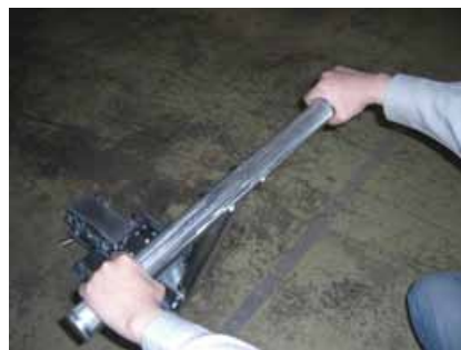
重荷重牽引向け大型センサーハンドル (自在キャスター舵取機構付)
